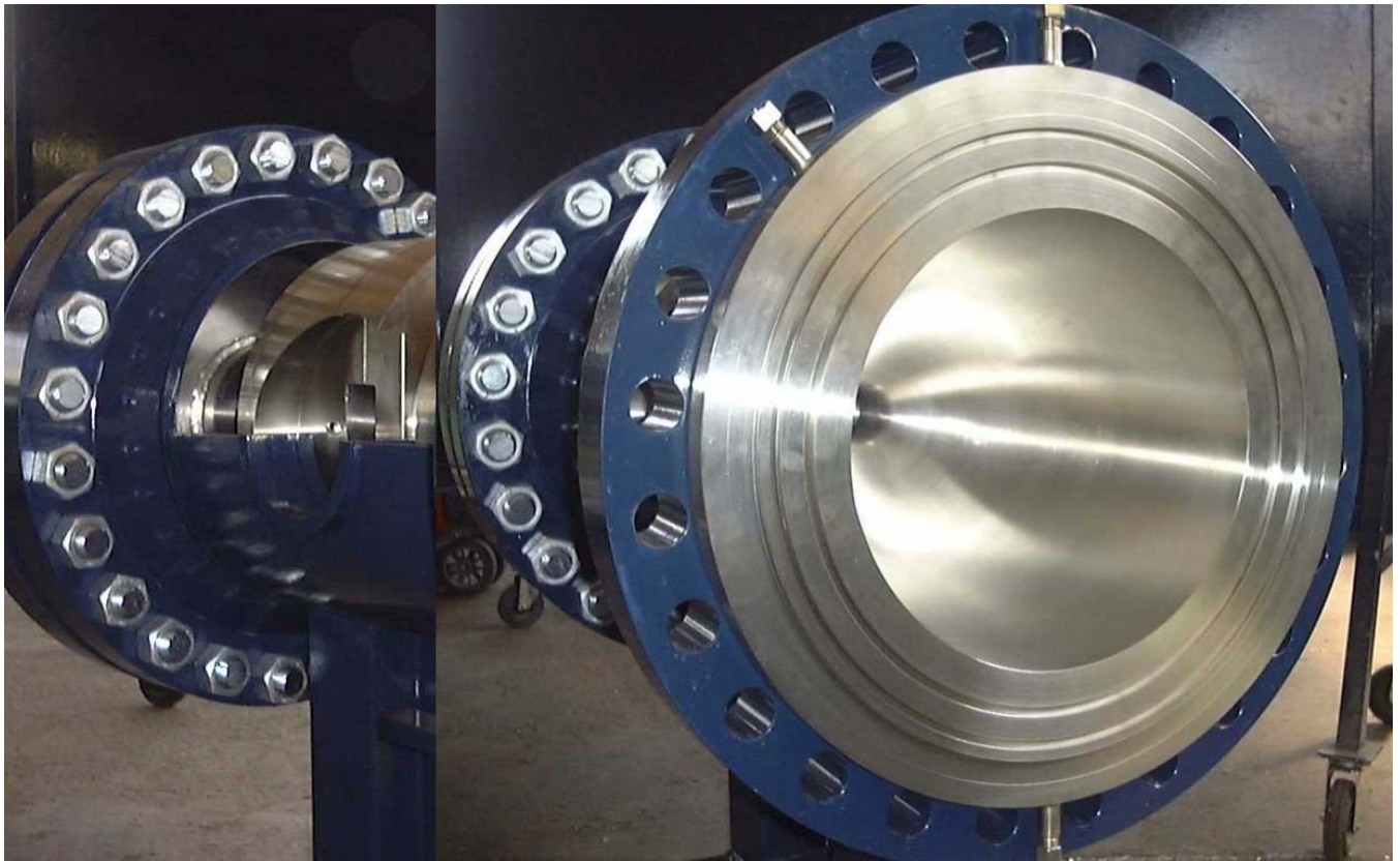
Abbildung: Durchflußprüfnormal 20" 600# für PTB Braunschweig 2004
