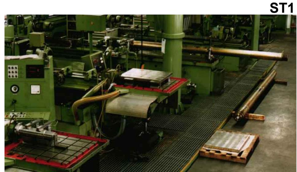
Abbildung: Tiefbohrmaschinen mit verschiedenen Werkstücken
