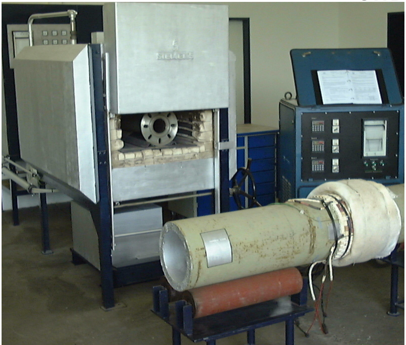
Abbildung: Glühofen, Ketten-Glühanlage
