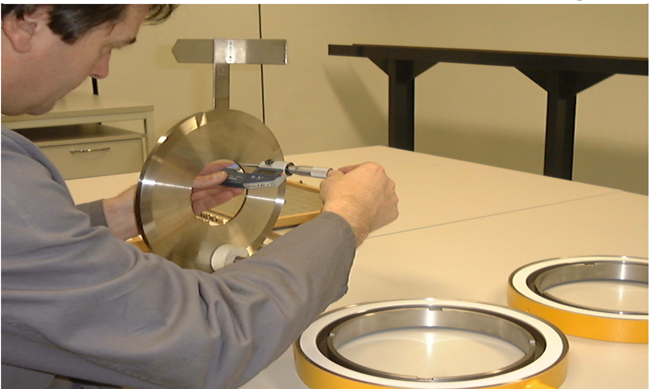
Abbild: Geometrische Ausmessung einer Ringkammerblende
